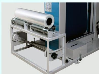
フィルム置き台の高さを上げることでフィルム交換時の腰への負担を軽減。
