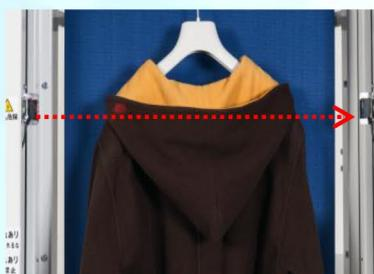
センサーにて厚手衣料、フード付き衣料を検知。包装を低速で行うことでフィルム破れ、落下を防ぎます。
