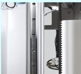
フィルムクランプ部の昇降ユニットにLMガイド（THK製）を使用。従来のスライドバックに比べ寿命が飛躍的に向上しました。さらに駆動用金属チェーンを廃止。ゴム製ベルトを採用し騒音を低減。
