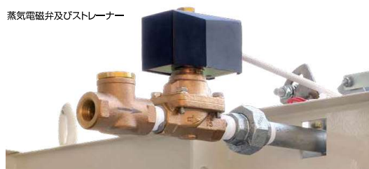
蒸気電磁弁及びストレーナー
